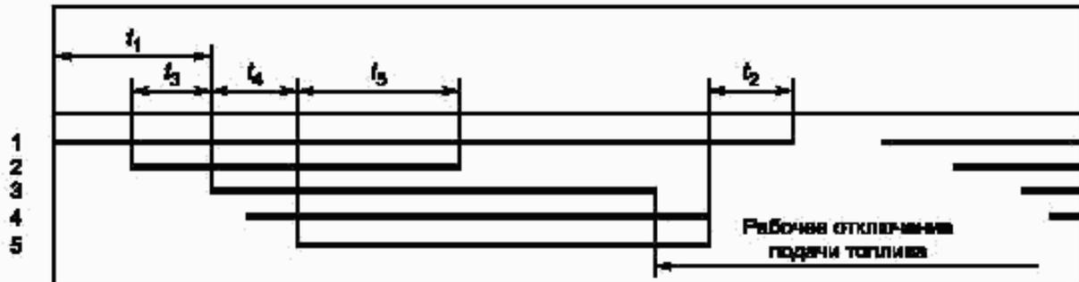
Диаграмма с защитным отключением подачи топлива при погасании пламени при розжиге
