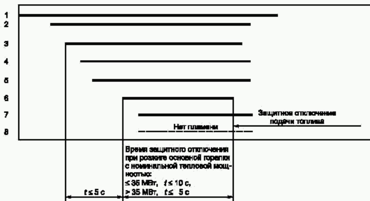
1 — поток воздуха; 2 — запальное устройство; 3 — сигнал на подачу топлива в запальную горелку; 4 — подача топлива в запальную горелку; 5 — наличие запального пламени; 6 — сигнал на подачу топлива в основную горелку; 7 — подача топлива в основную горелку; 8 — наличие основного пламени
